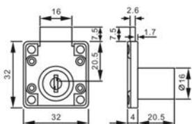
\* Модель "S" - ключ не вынимается при открытом положении замка
