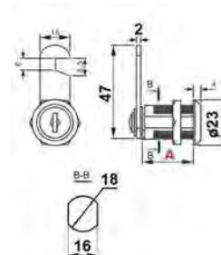
\* Модель «S» - ключ не вынимается при открытом положении замка
